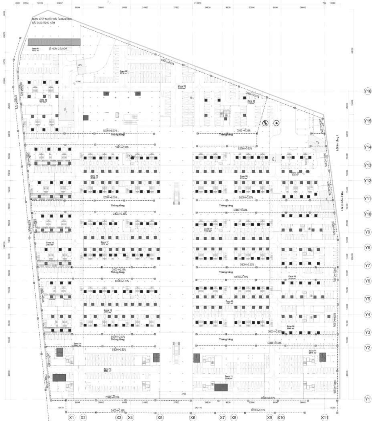
MẶT BẰNG THẢI NƯỚC THẢI SÀN ĐÈ XE COS-4.700
