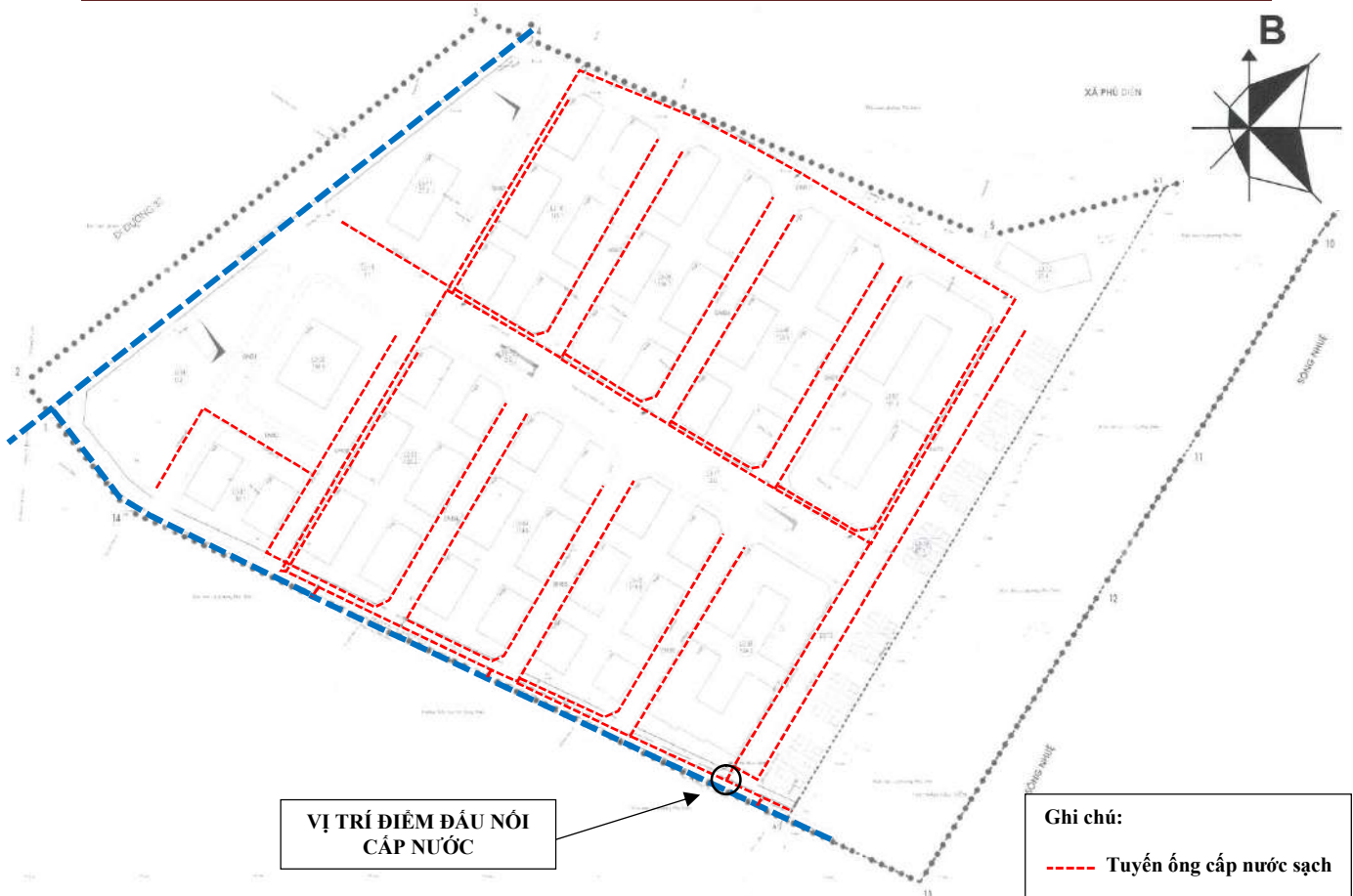
Hình 1.14. Hệ thống cấp nước của Dự án
